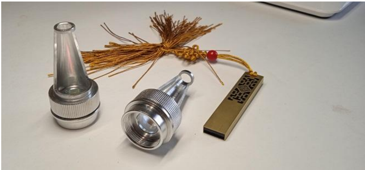
На фото насадка неодимового лазера для удаления татуировок ND:YAG 1064нм
