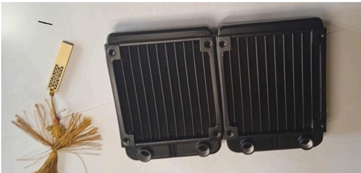
Пример радиатора для неодимового лазера \text{Nd:YAG} для карбонового пилинга и удаления татуажа.
